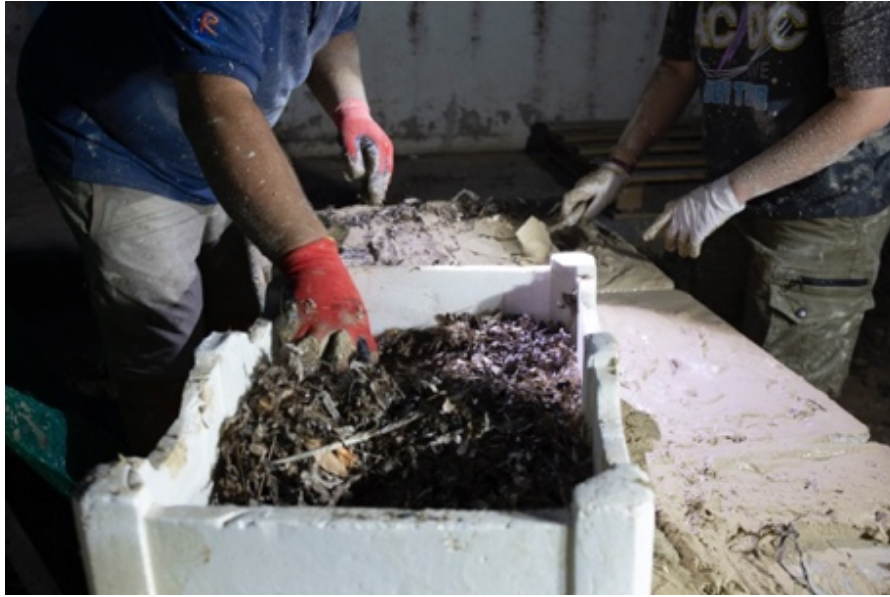
Il·lustració 17: sisè pas, ficar la posidònia seca a sobre de les plaques
