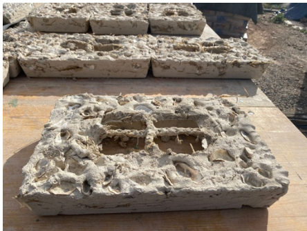
Il·lustració 6: model de placa per a posidònia, utilitza palla, trena de corda de moresc i closques d'ostres
